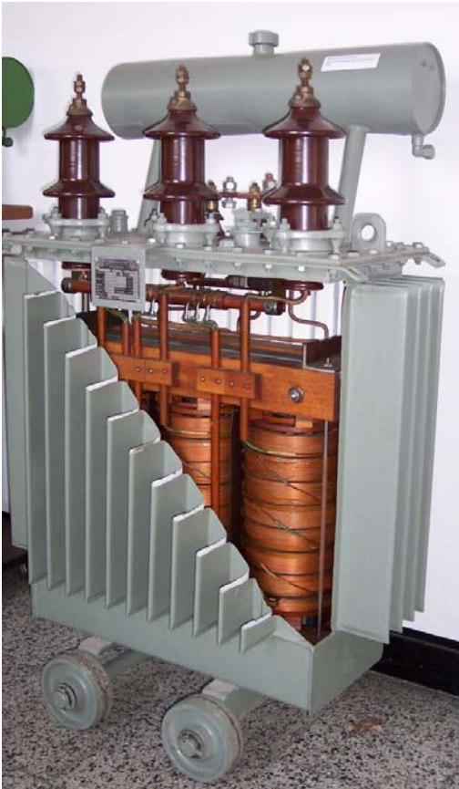
Figura 29. Transformador trifásico moderno. El reservorio de aceite es visible en la parte superior. Las aletas asisten en la disipación de calor.
